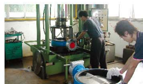
大型蝶閥試壓設備
